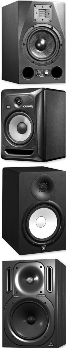
Abb. 1.2: Einige erschwingliche 2-Wege-Nahfeldmonitore mit Reflexöffnungen (von oben nach unten): Die ADAM A7X haben zwei kreisförmige Reflexrohre an jeder Seite des Tieftöners, die KRK Rokit 8 haben eine Reflexöffnung unterhalb des Tieftöners, die Behringer 2030A haben zwei schmale Reflexöffnungen auf jeder Seite des Hochtöners und die M-Audio DSM2 beherbergen eine einzelne Reflexöffnung auf der Rückseite.
