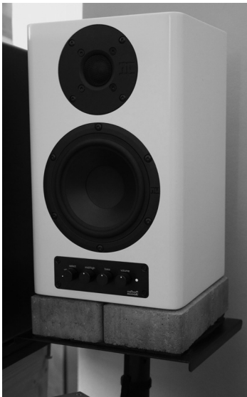
Abb. 1.6: Die Recoil Stabilizer von Primacoustic nehmen sich auf geschickte Weise einer Vielzahl der Probleme von Abhöranlagen in kleinen Studios zugleich an: Die gummierte obere Matte hält den Lautsprecher fest und fixiert ihn auf einer schweren Metallplatte und erhöht so die Trägheit, während die Schaumstoffunterlage den Lautsprecher hinsichtlich Körperschall vom Untergrund entkoppelt.
